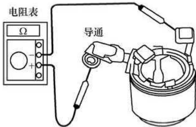
图 4-28 检查励磁绕组是否断路
