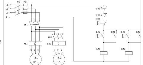
两台电机手动 顺序启动控制 线路-三角形接 法
