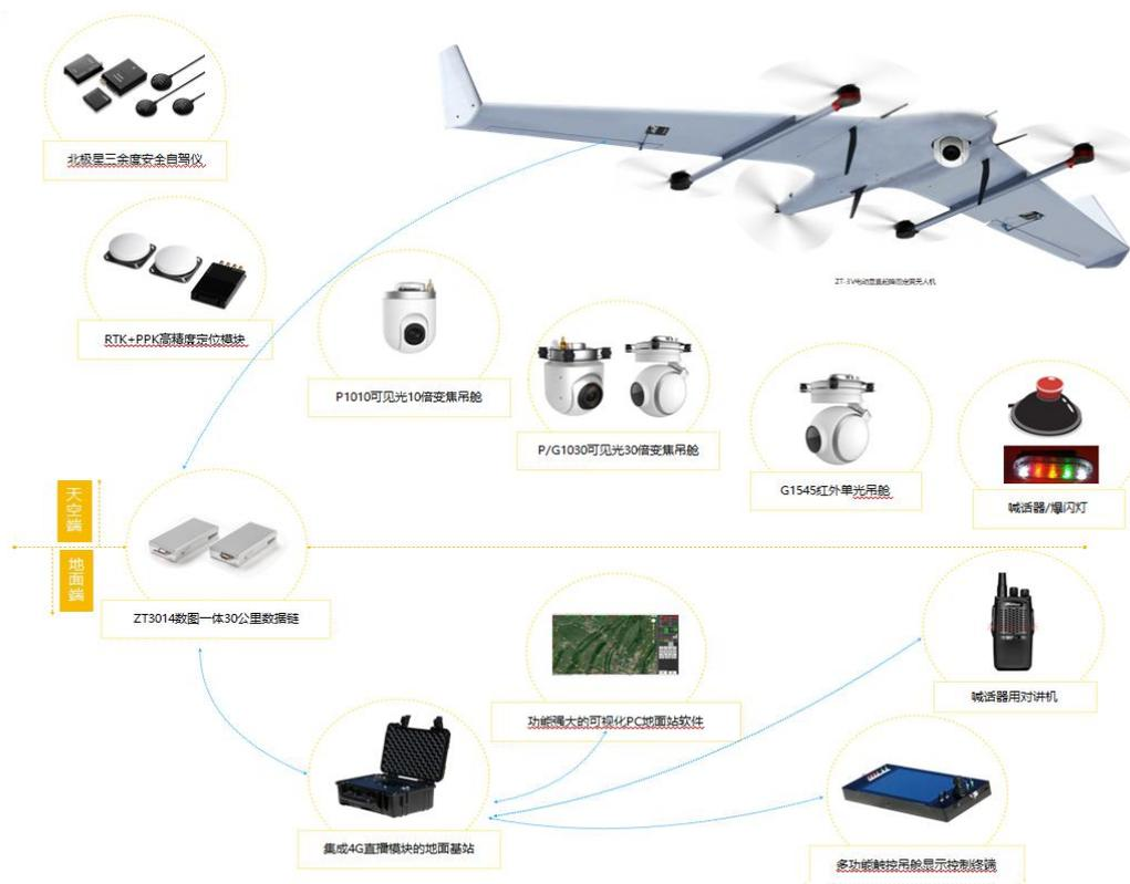
飞行器航电设备采用了三冗余度安全自驾仪,满足高低温、气压、环境应力等条件验证,内部算法融合了L1非线性与总能量控制算法,支持扩展智能视觉导航模块和RTK+PPK厘米级定位精度,一键完成旋翼和固定翼模式的自动切换,同时支持全自动和半自动等多种控制模式、航线规划、自动起飞、自动巡航、自动返航、特殊情况下自动切换旋翼模式迫降、“黑匣子”等功能。
